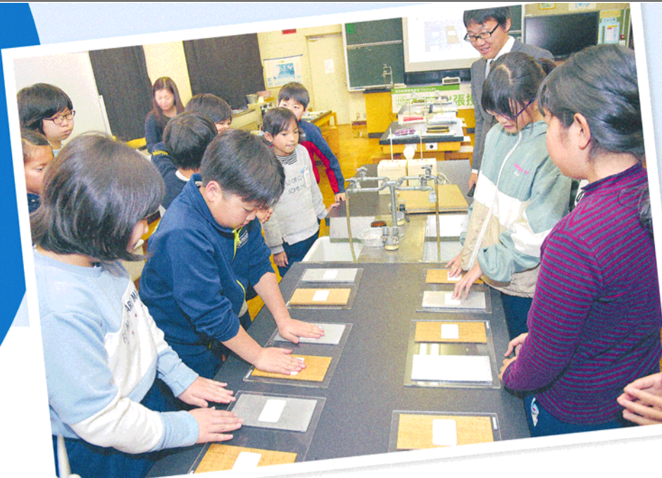
金属板と木の板に触れてみると金属の方が冷たく感じるが、温度はどちらも同じ。手の熱が多く奪われるため、金属の方が冷たく感じる
